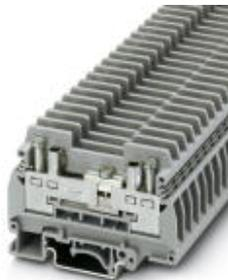
Messwandler-Trennklemme, mit zwei Prüfbuchsen für 4-mm-Prüfstecker oder zur Aufnahme von Schalt- oder Schraubbrücken, Anschlussart: Schraubanschluss, Querschnitt: 0,5 mm<sup>2</sup> - 10 mm<sup>2</sup>, AWG: 20 - 10, Breite: 8,2 mm, Montageart: NS 35/7,5, NS 35/15, NS 32, Farbe: grau
