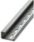
Tragschiene gelocht, G-Profil, Breite: 32 mm, Höhe: 15 mm, nach EN 60715: 2001, Material: Stahl, verzinkt, dickschichtpassiviert, Länge: 2000 mm, Farbe: silber
