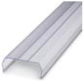
Abdeckprofil, zum Abdecken von Klemmenleisten, wird auf Abdeckprofilträger APT-ME oder Endhalter APH-ME gerastert. An den Enden und in Abständen von ca. 40 cm ist ein Abdeckprofilträger zu setzen. Lieferlänge: 1 m
