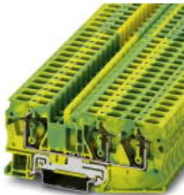
Schutzleiter-Reihenklemme, Anschlussart: Zugfederanschluss, Querschnitt: 0,2 mm<sup>2</sup> - 10 mm<sup>2</sup>, AWG: 24 - 8, Breite: 8,2 mm, Farbe: grün-gelb, Montageart: NS 35/7,5, NS 35/15
