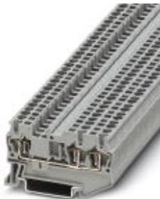
Durchgangsklemme, Anschlussart: Zugfederanschluss, Querschnitt: 0,08 mm<sup>2</sup> - 4 mm<sup>2</sup>, AWG: 28 - 12, Breite: 5,2 mm, Farbe: grau, Montageart: NS 35/7,5, NS 35/15
