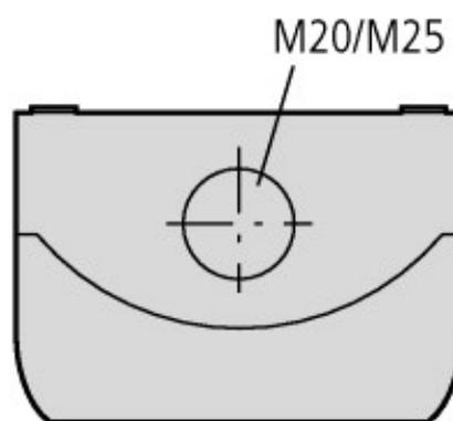
Leitungseinführung vorgepresst: unten: 2 x M16, oben: 1 x M20, seitlich: 2 x M20/M25 (je Seite 1 x)
