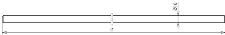
Fangstange beidseitig angefast, zum Schutz von Dachaufbauten, Kaminen usw., speziell für Betonsockel (17 kg) mit Keiltechnik oder für die Befestigung mit Stangenhaltern / Distanzhaltern.
