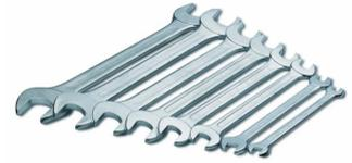
Doppelmaulschlüssel-Satz DIN 3110 und ISO 3318, Maulstellung 15 Grad, aus Chrom-Vanadium-Stahl, glanzverchromt 8-teilig 6x7, 8x9, 10x11, 12x13, 14x15, 16x17, 18x19, 20x22mm, mit Kunststoffclip
