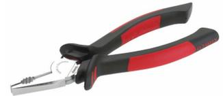
Kombinationszangen 180 mm DIN ISO 5746, eingelegetes Gelenk mit induktiv gehärteter Präzisionsschneide (ca. 64 HRC), für alle Drähte, auch für Pianodraht, aus Spezialwerkzeugstahl, mit leicht konischen, gezahnten Greifflächen und gezahnter Aussparung (Brennerloch)
