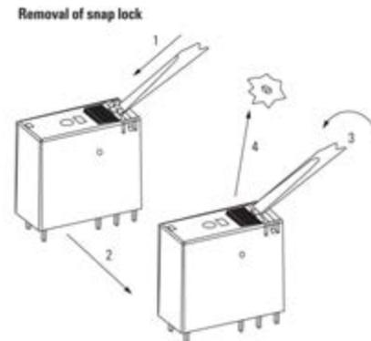
Entfernen der Rastsperrung der Prüftaste
