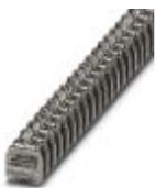
Anschlussklemme, Anschlussart Schraubanschluss, Belastungsstrom: 41 A, Querschnitt: 0,5 mm<sup>2</sup> - 6 mm<sup>2</sup>, Breite: 7 mm, Farbe: silber
