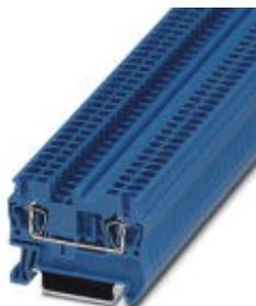
Durchgangsklemme, Anschlussart: Zugfederanschluss, Querschnitt: 0,08 mm<sup>2</sup> - 4 mm<sup>2</sup>, AWG: 28 - 12, Breite: 5,2 mm, Farbe: blau, Montageart: NS 35/7,5, NS 35/15
