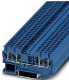
Durchgangsklemme, Anschlussart: Zugfederanschluss, Querschnitt: 0,08 mm<sup>2</sup> - 4 mm<sup>2</sup>, AWG: 28 - 12, Breite: 5,2 mm, Farbe: blau, Montageart: NS 35/7,5, NS 35/15
