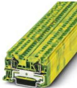
Zugfeder-Schutzleiterklemme, Anschlussart: Zugfederanschluss, Querschnitt: 0,08 mm<sup>2</sup> - 6 mm<sup>2</sup>, AWG: 28 - 10, Breite: 6,2 mm, Farbe: grün-gelb, Montageart: NS 35/7,5, NS 35/15
