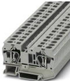
Durchgangsklemme, Anschlussart: Zugfederanschluss, Querschnitt: 0,2 mm<sup>2</sup> - 10 mm<sup>2</sup>, AWG: 24 - 8, Breite: 8,2 mm, Farbe: grau, Montageart: NS 35/7,5, NS 35/15
