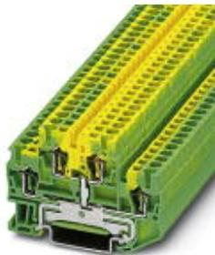
Schutzleiter-Doppelstockklemme, Querschnitt: 0,08 mm<sup>2</sup> - 4 mm<sup>2</sup>, AWG: 28 - 12,
