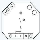
**1 Schließer nicht potenzialfrei 10 A/250V AC, Glühlampen 2000 W, Rückfallverzögerung mit Ausschaltvorwarnung und Taster-Dauerlicht zuschaltbar. Stand-by-Verlust nur 0,7 Watt.**
