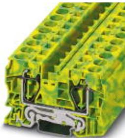
Zugfeder-Schutzleiterklemme, Anschlussart: Zugfederanschluss, Querschnitt: 0,2 mm<sup>2</sup> - 25 mm<sup>2</sup>, AWG: 24 - 4, Breite: 12,2 mm, Farbe: grün-gelb, Montageart: NS 35/7,5, NS 35/15
