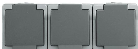
3-fach Schuko-Steckdose, 16 A, 250 V~, DIN 49440, waagrecht, mit Klappdeckel, 2-polig + PE, vorverdrahtet, schraubenlose Steckklemme, aus bruchsicherem Thermoplast, Federn rostfrei, Verbindungsklemmen gemäß VDE
