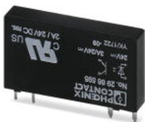
Steckbares Miniatur-Solid-State-Relais, Leistungs-Solid-State-Relais, 1 Schließer, Eingang: 24 V DC, Ausgang: 3-33 V DC/3 A
