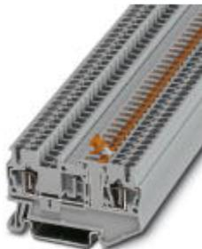
Messertrennklemme, Anschlussart: Zugfederanschluss, Querschnitt: 0,08 mm<sup>2</sup> - 4 mm<sup>2</sup>, AWG: 28 - 12, Nennstrom: 20 A, Nennspannung: 400 V, Länge: 60,5 mm, Breite: 5,2 mm, Farbe: grau, Montage: NS 35/7,5, NS 35/15
