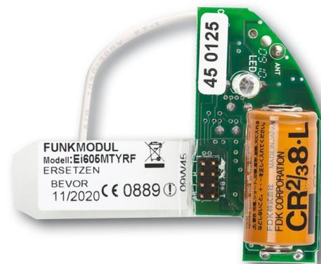
Zur drahtlosen Vernetzung von bis zu 20 Busch-Rauchalarm®/-Wärmealarm Produkten (6833/01-84, 6835/01-84).
