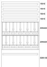
**Montageinsatz für Zählerverteiler, B=1120mm, H=1950mm, 10 Zählerplätze**
