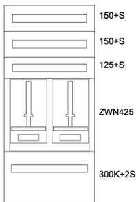
**Montageinsatz für Zählerverteiler, B=520mm, H=1150mm, 2 Zählerplätze**
