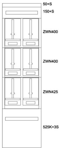
Montageinsatz für Zählerverteiler, B=520mm, H=1950mm, 6 Zählerplätze
