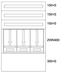
Montageinsatz für Zählerverteiler, B=720mm, H=1150mm, 3 Zählerplätze
