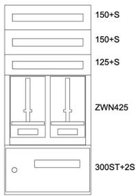
**Montageinsatz für Zählerverteiler, B=520mm, H=1150mm, 2 Zählerplätze**
