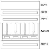
**Montageinsatz für Zählerverteiler, B=920mm, H=1150mm, 4 Zählerplätze**
