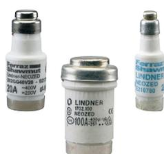
Das DO Sicherungs-System findet in Niederspannungs-Anlagen Anwendung, in denen die Sicherungs-Einsätze Laien zugänglich sind und durch diese ausgewechselt werden können. Es ist das modernste Schraub-Sicherungs-System und für 400VAC/250VDC ausgelegt. Die Baugrößen D01, D02 und D03 bilden das DO System.
