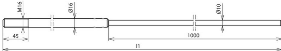
Fangstange mit Verjüngung (1000 mm) Gewinde M16, zum Schutz von Dachaufbauten, Kaminen usw., speziell für Betonsockel (17 kg) mit Gewindeadapter.
