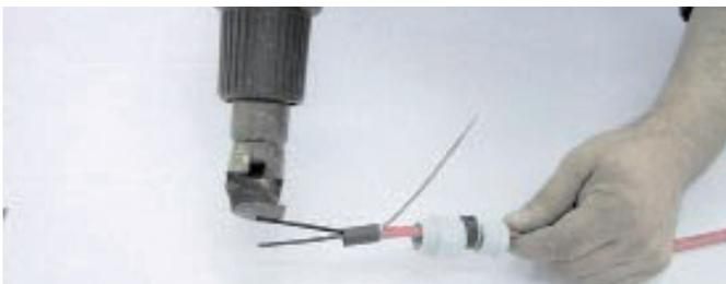
5. Föhnen Sie den Schumpfschlauch 9/3 20 mm mittels Heißluftföhn auf.
