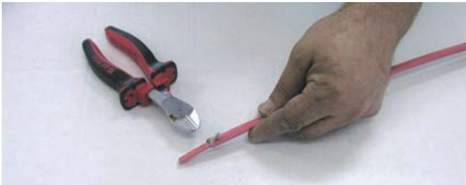
3. Zwickeln Sie das Schutzgeflecht mittels Seitenschneider auf ca. 10 mm ab und schieben Sie es zurück.
