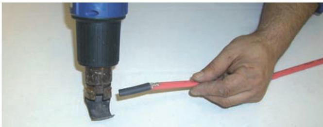
4. Föhnen Sie den Schrumpfschlauch 9/3 40 mm mittels Heißluftföhn auf und drücken Sie das Ende des Schrumpfschlauchs mittels einer Flachzange für ca. 10 Sekunden zusammen.
