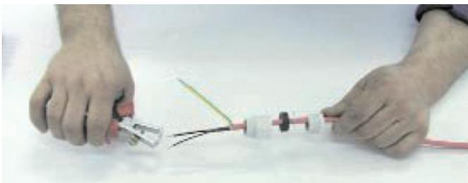
7. Isolieren Sie die Litzen mittels Abisolierzange ca. 10 mm ab.
