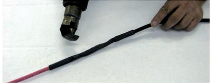
8. Stecken Sie den Aussenschumpfschlauch mittig über die Konfektionierung und beginnen Sie von der Mitte aus mit dem Aufföhnen.
