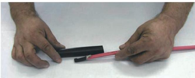
5. Föhnen Sie den Außenschumpfschlauch mittels Heißluftföhn auf und drücken Sie das Ende des Schrumpfschlauchs mittels einer Flachzange für ca. 10 Sekunden zusammen.
