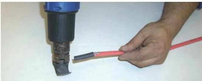
4. Föhnen Sie den Schrumpfschlauch mittels Heißluftföhn auf und drücken Sie das Ende des Schrumpfschlauchs mittels einer Flachzange für ca. 10 Sekunden zusammen.
