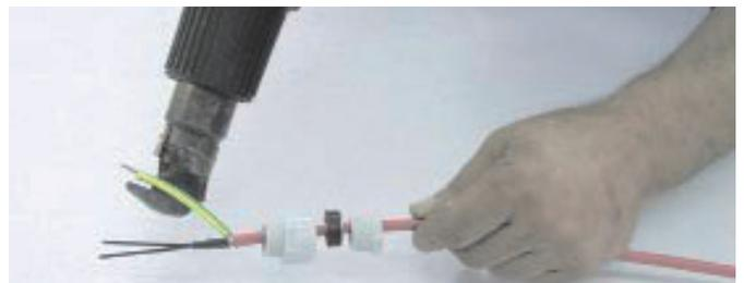
6. Föhnen Sie den Erdungsschumpfschlauch mittels Heißluftföhn auf.
