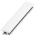
Zackband, Streifen, weiß, beschriftet, beschriftbar mit: Plotter, quer bedruckt: fortlaufende Zahlen 1-10, 11-20 usw. bis 491-500, Montageart: Verrasten in hoher Schildchennut, für Klemmenbreite: 6,2 mm, Schriftfeldgröße: 6,15 x 10,5 mm
