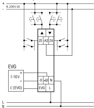
Die Zugbügelklemmen der Anschlüsse müssen geschlossen sein, also die Schrauben eingedreht, um die Gerätefunktion prüfen zu können.
