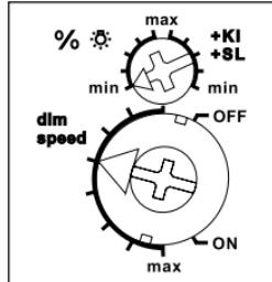
Mit dem %-Drehschalter kann die Mindesthelligkeit (voll abgedimmt) eingestellt werden. Gleichzeitig wird festgelegt, ob die Kinderzimmerschaltung und die Schlummerschaltung aktiv sind (+KI +SL).
