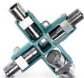
Schaltchrankschlüssel, aus Metall, für alle gängigen Schließungen: Doppelbart 3 - 5 mm, Vierkant 5 mm, 6 mm, 7 - 8 mm, 9 - 10 mm, Dreikant 7 mm, 8 - 9 mm, 10 - 11 mm, Sonder 6 mm
