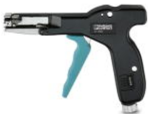
Kabelbinderzange, für Kunststoffkabelbinder mit Breite 2,2 - 4,8 mm, Materialstärke bis 1,6 mm
