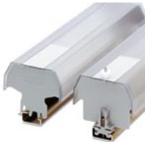
Abdeckprofil, zum Abdecken von Klemmleisten, wird auf Abdeckprofilträger AP 3-TU, AP 3-TNS 35 gerastert, beschriftbar mit Einsteckstreifen AP-ES. An den Enden und in Abständen von ca. 40 cm ist ein Abdeckprofilträger zu setzen. Lieferlänge: 1 m
