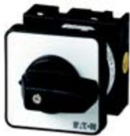
Stufenschalter, Kontakte: 8, 20 A, Frontschild: 1-4, 45°, 4 Stufen 45°, rastend, Einbau
