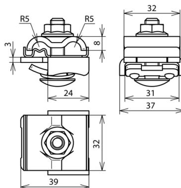
Falzklemme zum Einbinden der Montagesysteme z. B. von PV-Anlagen in den Funktionspotentialausgleich/Funktionserdung (Leiterfarbe ggf. schwarz) und Blitzschutz-Potentialausgleich nach DIN EN 62305-3 (VDE 0185-305-3)
