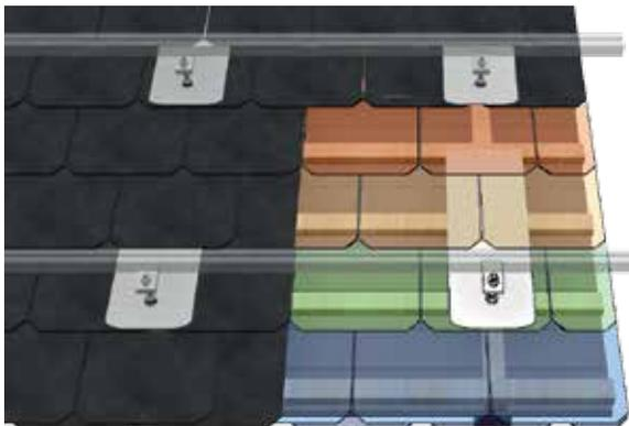
Nach Prüfung der Dacheignung ist für die Auslegung der richtigen SlatePlan-Variante vor allem die Überdeckungshöhe zu beachten.
