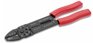
Presszange Economy für isolierte und nicht isolierte Kabelschuhe, mit Draht- und Schraubenabschneider bis M5, sowie Abisoliervorrichtung 0, 5-6 mm<sup>3</sup>, Pressung von Litze und Kabelisolation erfolgt in 2 Arbeitsgängen Ovalpressung 0, 5-6 mm<sup>3</sup>, Länge 220mm
