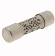
Sicherungseinsatz, hohe Drehzahl, 12 A, DC 1000 V, IEC60269-6 type A, 10 x 38 mm, gPV, UL PV, UL, IEC
