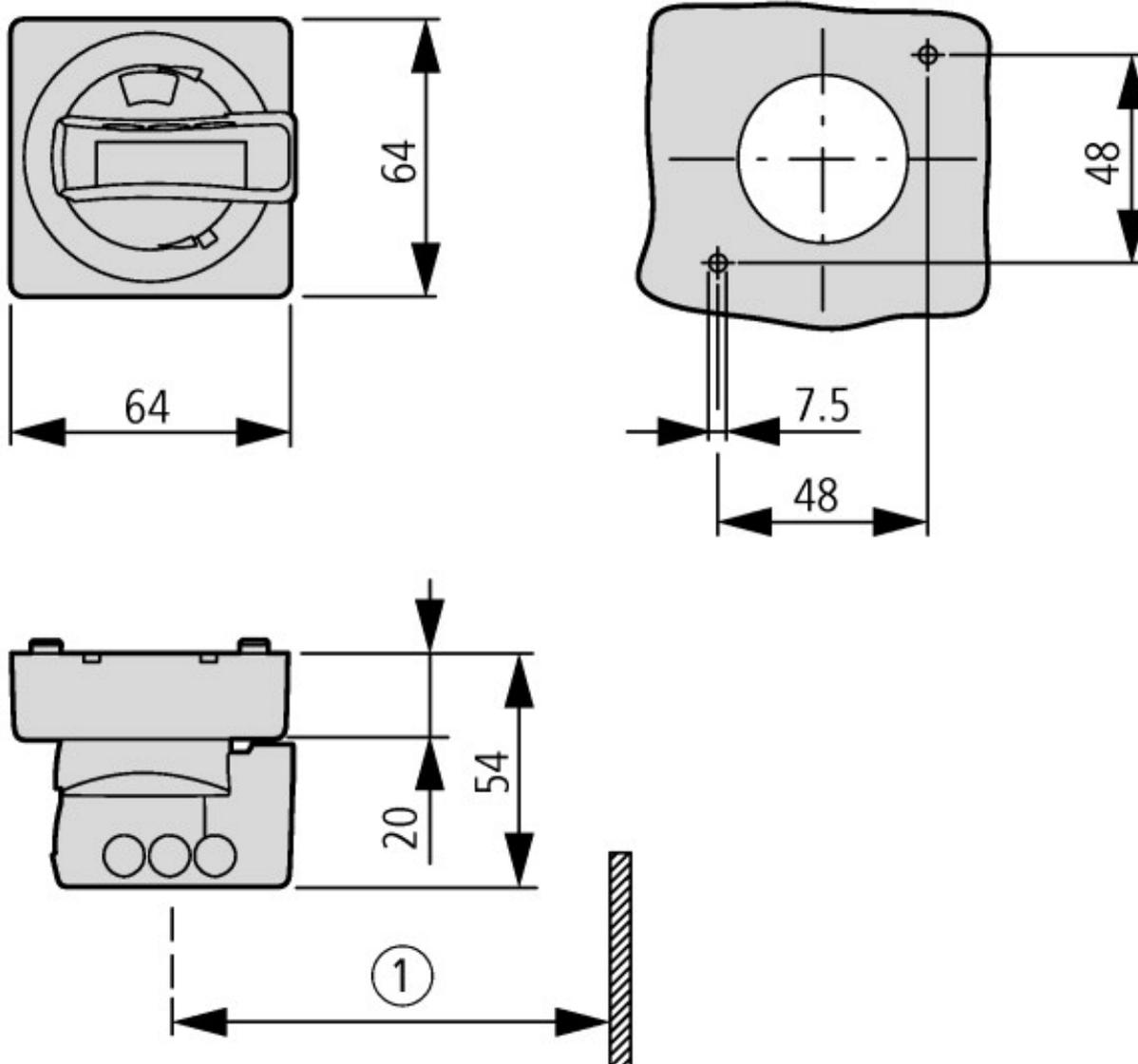
Einbautiefe: 125 bis 240 mm von der Oberkante DIN-Hutschiene bis Vorderkante Schranktür/Deckel
