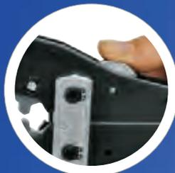
Einhandbetätigte synchronisierte Profilscheiben, Verstellung im geöffneten Zustand
