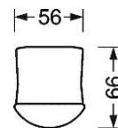
Lichtleiste; Gehäuse aus profiliertem Stahlblech, verwindungssteif, längsseitig talliert, die Profilierung des Oberteils bildet einen Kabelkanal für Mantelleitung bis 5 x 1,5 qmm; Gehäusefarbe Verkehrsweiß RAL 9016; freistrahlend; Elektrischer Anschluss über 3-polige Anschlussklemme in Steckkontakt-Technik.
