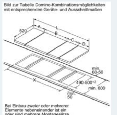
Bei Einbau zweier oder mehrerer Elemente nebeneinander ist ein oder sind mehrere Montagesätze erforderlich (2 Elemente 1 Montagesatz, 3 Elemente 2 Montagesätze usw).
