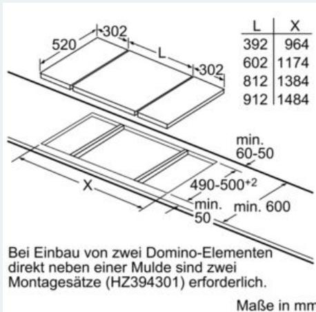
Bei Einbau von zwei Domino-Elementen direkt neben einer Mulde sind zwei Montagesätze (HZ394301) erforderlich.
