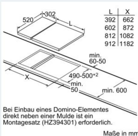
Bei Einbau eines Domino-Elementes direkt neben einer Mulde ist ein Montagesatz (HZ394301) erforderlich.
