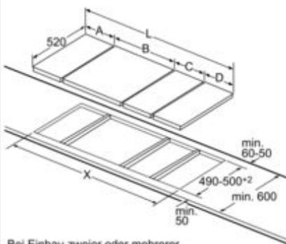
Bei Einbau zweier oder mehrerer Elemente nebeneinander ist ein oder sind mehrere Montagesätze erforderlich (2 Elemente 1 Montagesatz, 3 Elemente 2 Montagesätze usw.). Domino-Kombinationsmöglichkeiten mit entsprechenden Geräte- und Ausschnittmaßen
