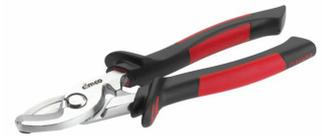
Einhand-Kabelschere für Kupfer- und Aluminiumkabel, sehr gute Schneidleistung, glatter, deformationsfreier Schnitt, im Gesenk geschmiedet, mit Präzisionsschliff, stellbarem Schraubgelenk, 2-Komponenten-Kunststoff-Griffhüllen für Kabel bis 25 mm massiv 25 mm<sup>3</sup> flexibel bis 70 mm<sup>3</sup> 200 mm lang
