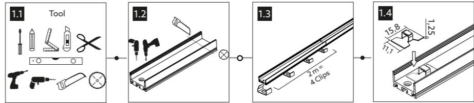
Percer le passage de câble et coller le support de câble afin d'éviter tout risque d'endommagement. Utilisez les attaches de montage BILTON correspondantes pour le montage.
