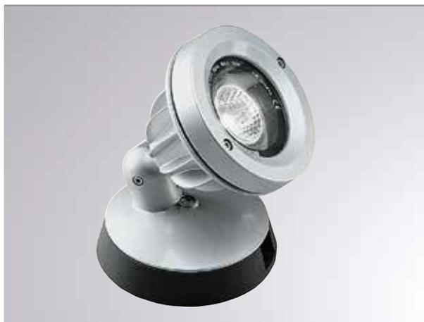
Aufbaustrahler, Aluminiumdruckguss, Dreiphasen Pulverbeschichtung, silber, 90° schwenkbar, mit breiten Kühlrippen für eine hohe Wärmeableitung, Socket aus bruchfestem Polyamid, gehärtetes Siebdruckglas, inkl. Leuchtmittel
