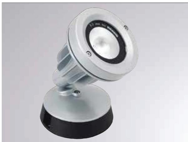
Aufbaustrahler, Aluminiumdruckguss, Dreiphasen Pulverbeschichtung, silber oder graphit, 90° schwenkbar, mit breiten Kühlrippen für eine hohe Wärmeableitung, 46° Ausstrahlwinkel, Socket aus bruchfestem Polyamid, gehärtetes Siebdruckglas, inkl. Konverter
