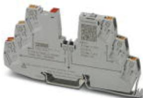
Einkanaliger, elektronischer Geräteschutzschalter zum Schutz von Verbrauchern an 24 V DC bei Überlast und Kurzschluss. Einfache Potenzialverteilung mit den Komponenten aus dem Reihenklemmensystem CLIPLINE complete. Mit elektronischer Verriegelung der eingestellten Nennströme. Zur Installation auf DIN-Tragschienen.
