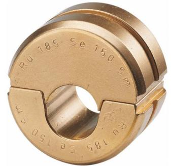
Presseinsätze für System-Presszangen Nr. 10 5500 und Nr. 10 5700 zum Runddrücken von Al- und Cu-Sektorleitern für 3- und 4-Sektorleiter, Rundrückbreite 19, 5mm
