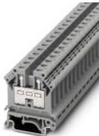
Durchgangsklemme, Anschlussart: Schraubanschluss, Anzahl der Anschlüsse: 2, Querschnitt: 0,5 mm<sup>2</sup> - 10 mm<sup>2</sup>, AWG: 20 - 8, Breite: 8,2 mm, Farbe: grau, Montageart: NS 35/7,5, NS 35/15
